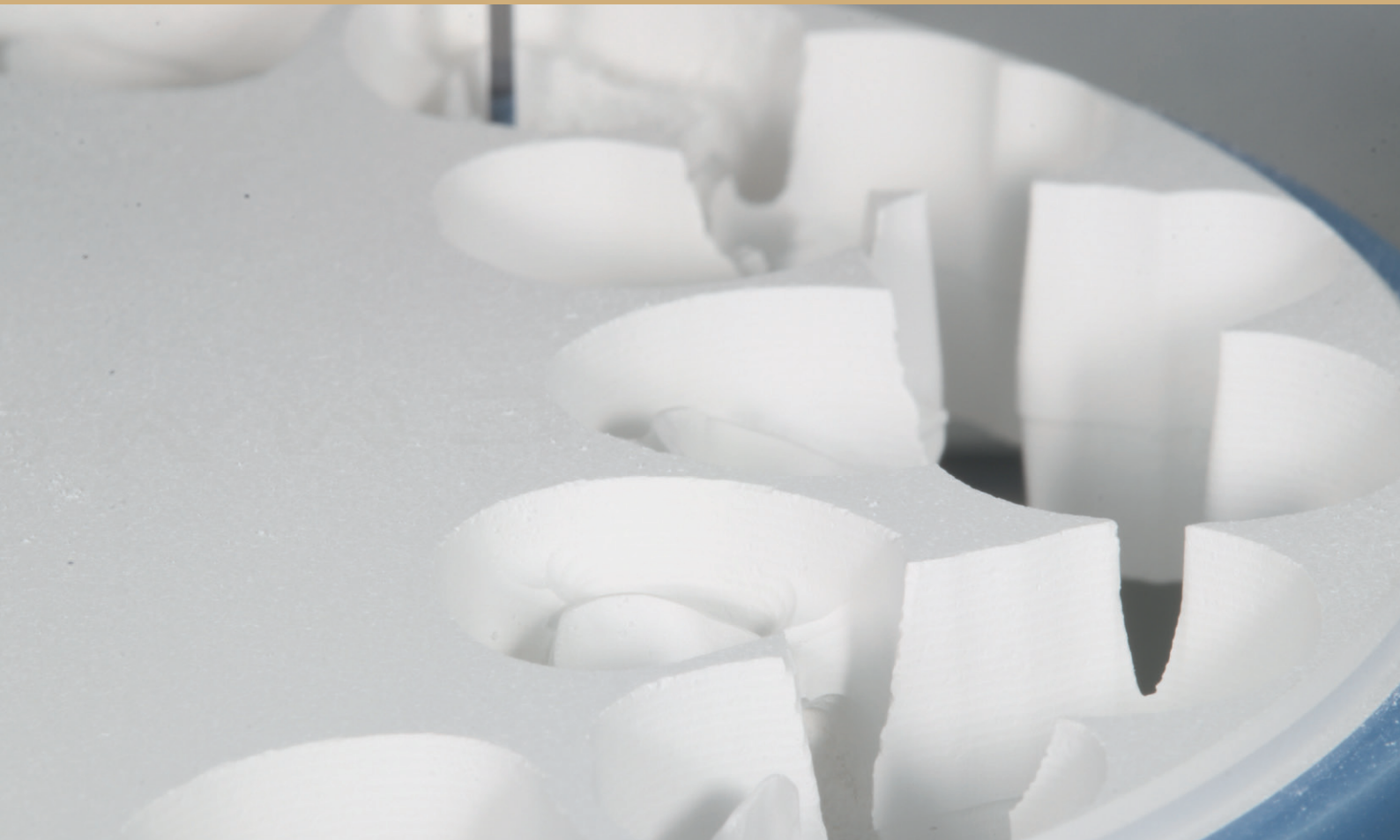
Obrázek 25: Postup frézování: Všimněte si tenkých a čistých okrajů.
